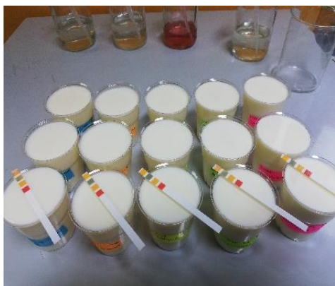
Slika 9: Merjenje s pH listki (lasten vir)
