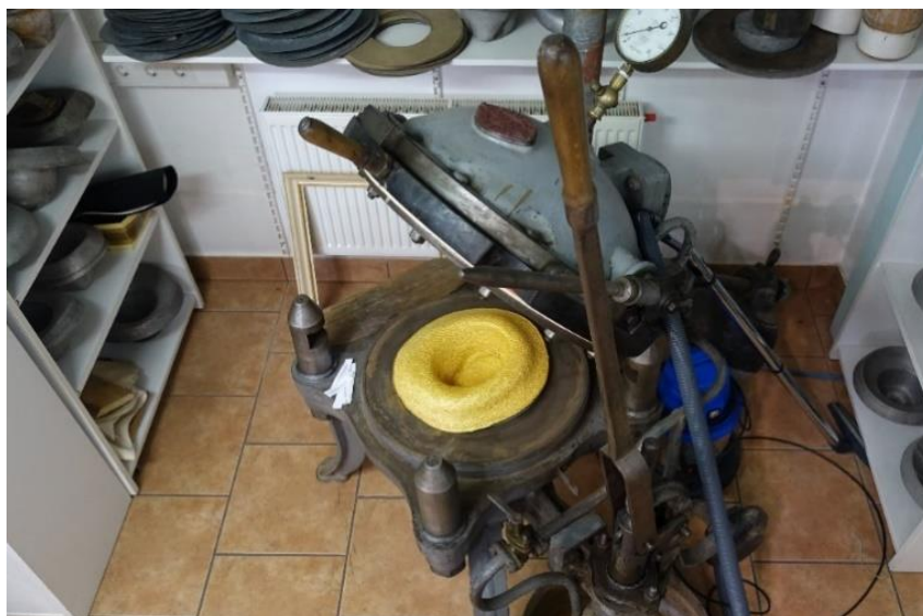
Slika 61: Parni stiskalni stroj za oblikovanje slamnikov
