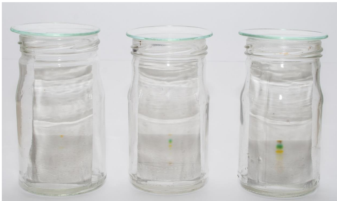
Slika 6: Kozarci, v katerih je potekala kromatografija
