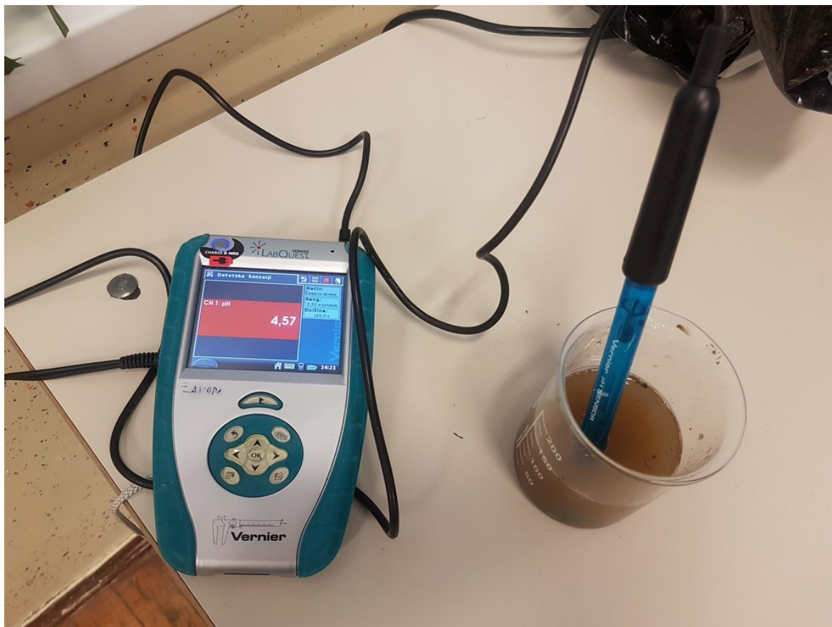
Slika 25: Merilnik pH in vmesnik LabQuest Vernier (foto N. Turičnik Kleč).
