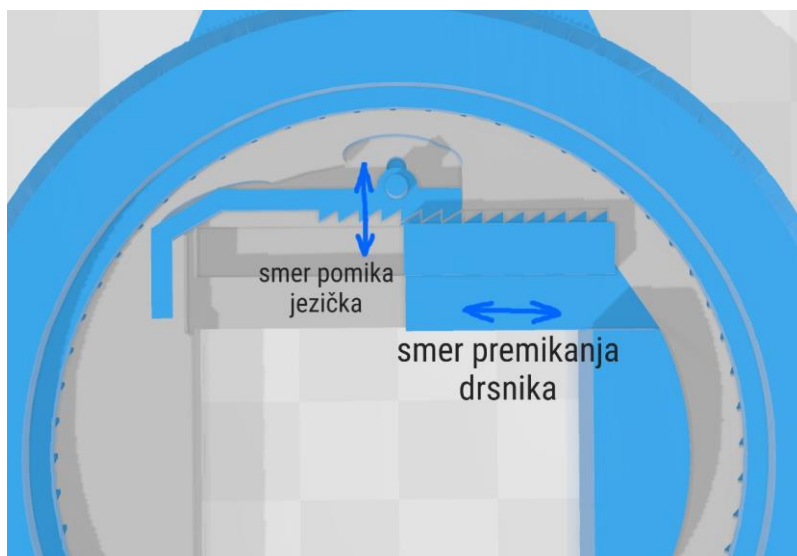
Slika 8: Princip vrtenja z jezočkom
