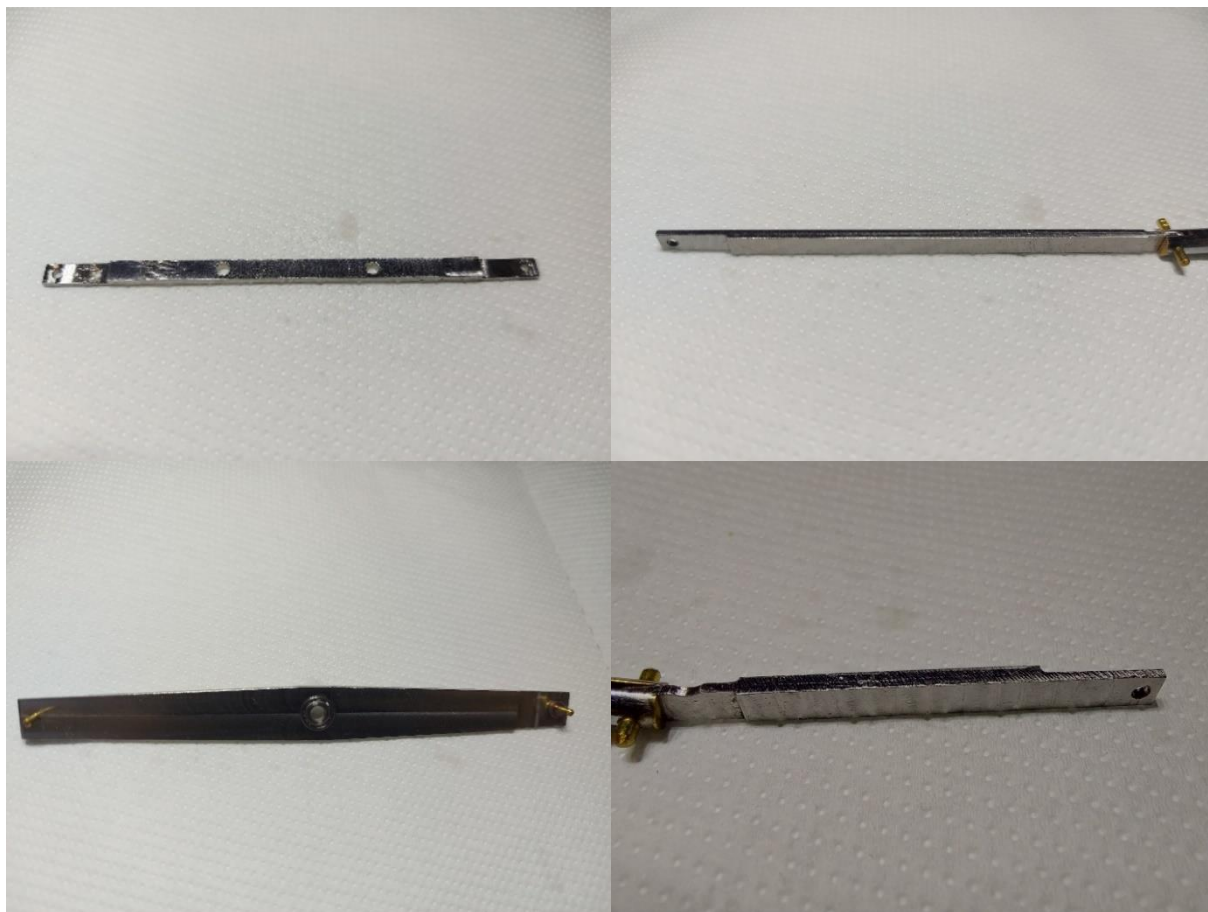
Slika 50: Ojnice in glavna ročica po izdelavi
