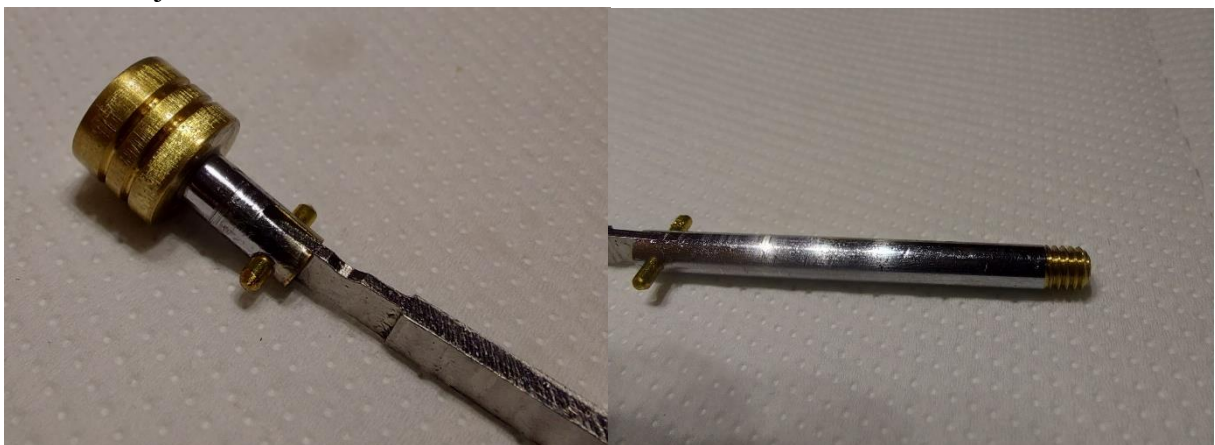
Slika 60: Batnice že sestavljene e ojnicami
