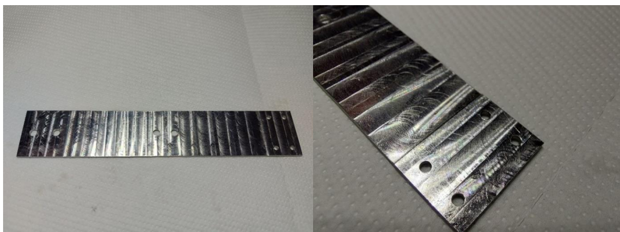
Slika 49: Nosilna plošča po izdelavi
