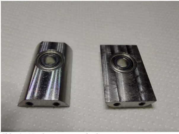
Slika 64: Nosilec ročične gredi z ležaji
