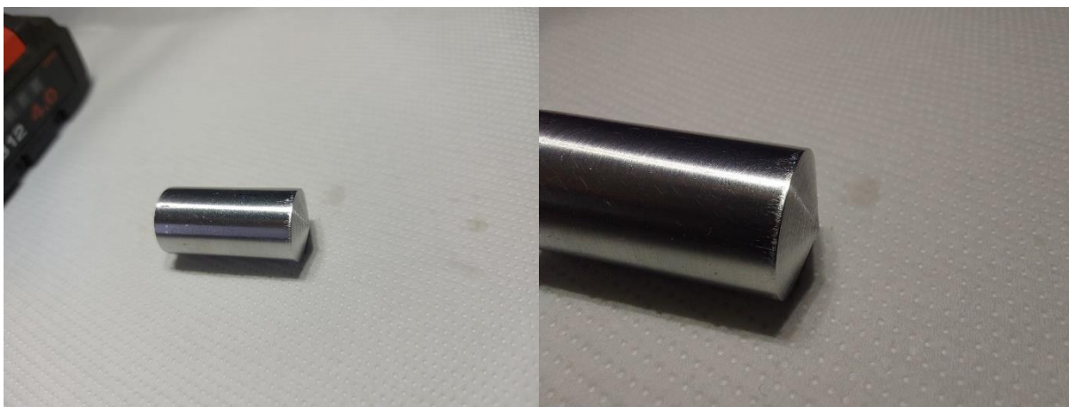
Slika 55: Ekspanzijski bat po izdelavi in združitvi delov
