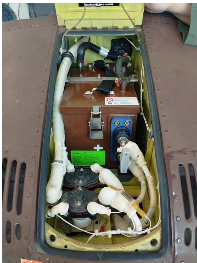
SLIKA 9: Nikel- kadmijeva baterija v helikopterju bell 206
