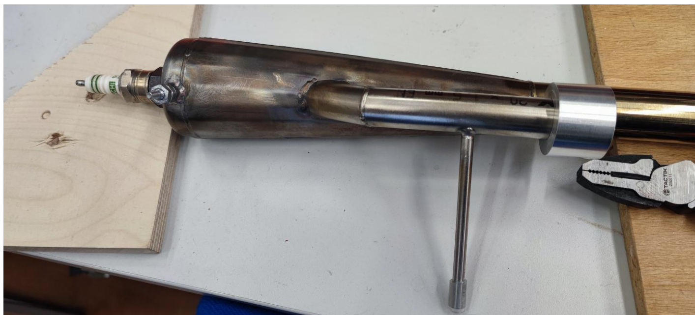
Zgorevalna komora in sesalni prostor z vidno vžigalno svečko in iglo vbrizgalnega sistema.
