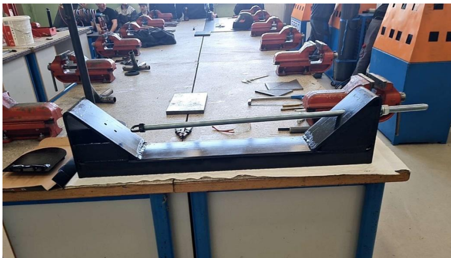
Slika 41: Končana konstrukcija za testiranje oprimkov
