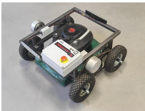
Slika 8: v plastičnem ohišju je nameščeno drobovje za krmiljenje motorjev
