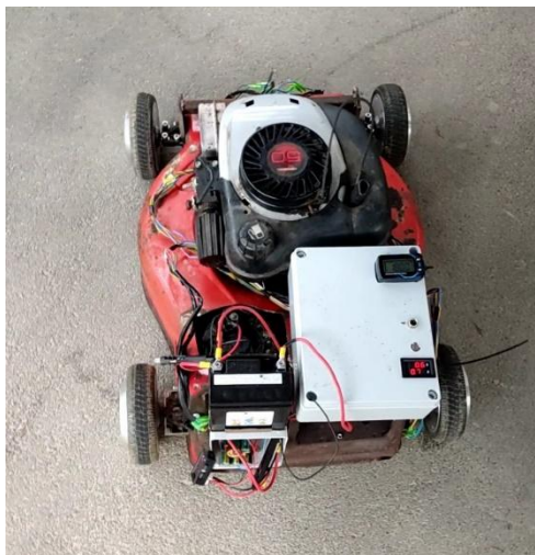
Slika 2: prvi prototip, kjer smo testirali pogon s štirimi direktnimi motorji
