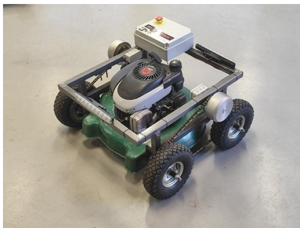
Slika 7: drugi prototip, predmet te naloge: pogon z dvema motorjema preko verige
