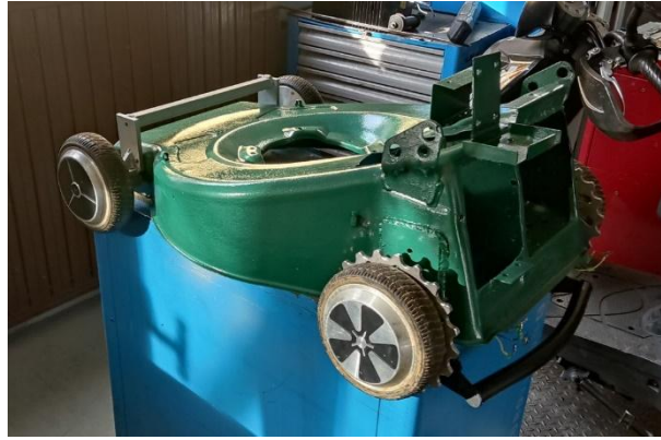
Slika 4: dodatni jekleni obroči na kolesih za izboljšanje trakcije
