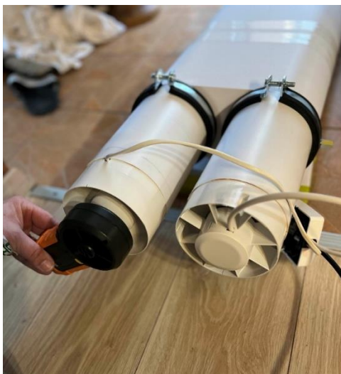
Slika 22: Merjenje pretoka, temperature in vlažnosti (vir: osebni arhiv)
