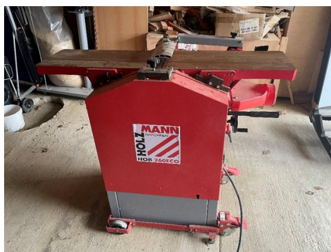
Slika 42: Debelinski skobeljni stroj Holzmann – debelinka poravnalka (lastni vir)
