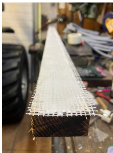
Slika 46: Nalepljen samolepilni suhoomotažni bandažni trak na letvi (lastni vir)
