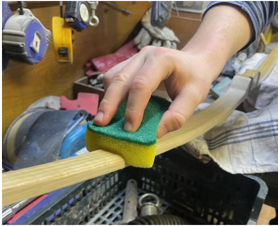
Slika 60: Proces nanašanja olja (lastni vir)
