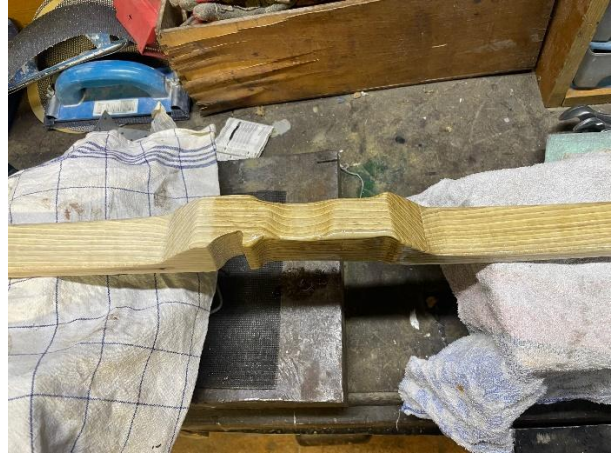
Slika 61: Delno nanešeno olje na loku (lastni vir)
