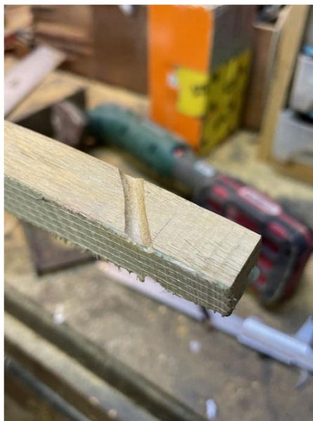
Slika 48: Dokončno izdelan utor za vrv in tetivo (lastni vir)
