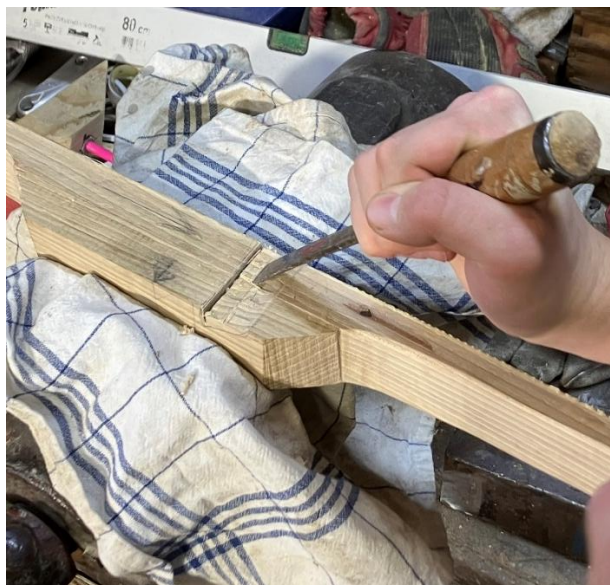
Slika 58: Dolbenje slona za puščice (lastni vir)
