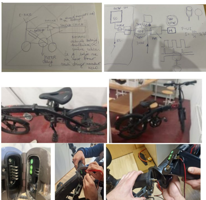
Slika 8: Načrt in namestitve baterije
