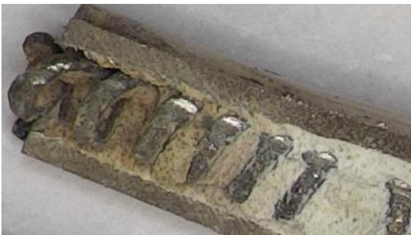
Slika 23: Notranjost grelnega elementa, kontaminiranega z oljem, po segrevanju na 300 °C.
