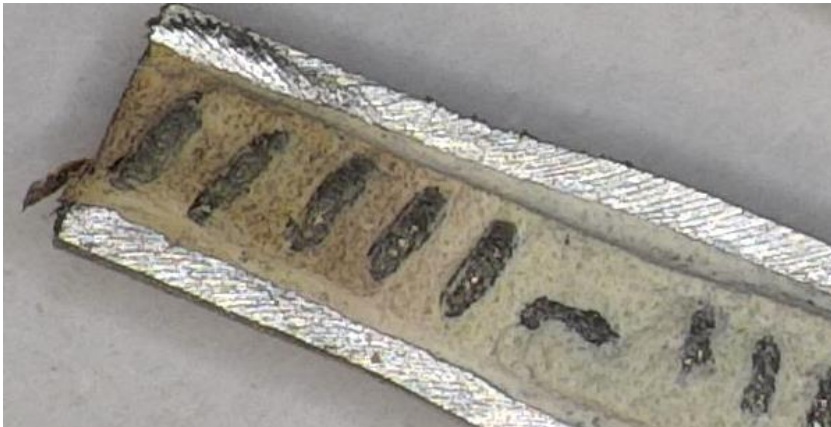
Slika 21: Notranjost grelnega elementa, kontaminiranega z oljem, po segrevanju na 200 °C.
