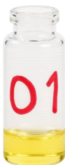
Slika 10: Vzorce olja smo postavili v peč in jih eno uro segrevali na 100, 150, 200, 250 in 300 °C.
