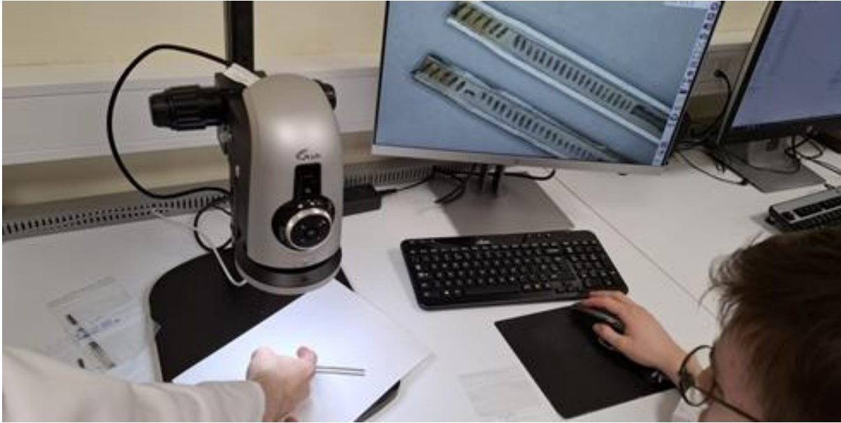
Slika 11: Slikanje prerezanih svečk z digitalno lupo.
