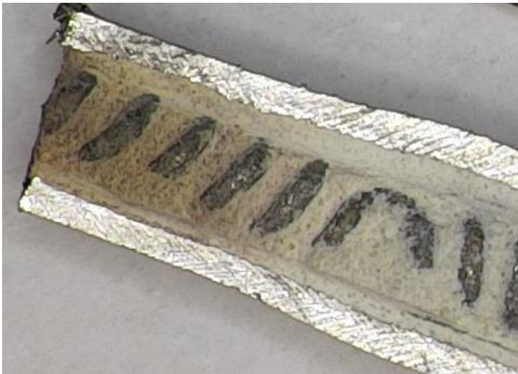
Slika 22: Notranjost grelnega elementa, kontaminiranega z oljem, po segrevanju na 250 °C.
