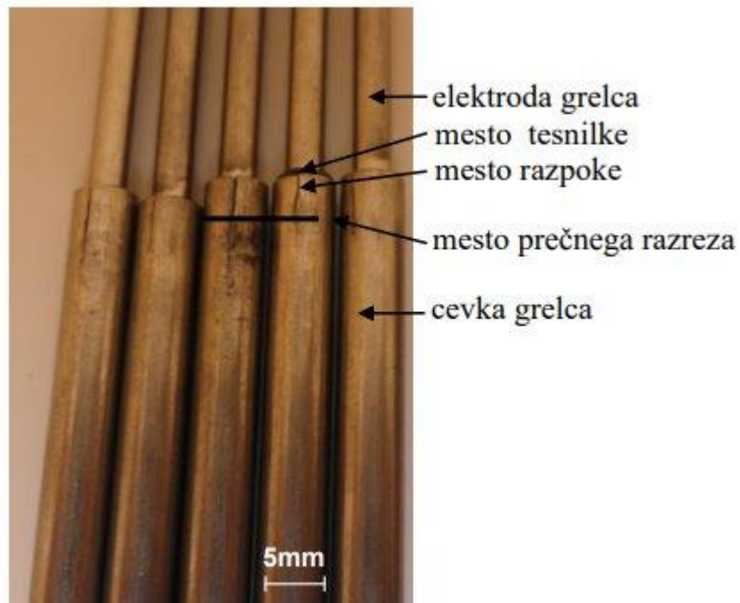
Slika 6: Mehanske poškodbe ohišja svečke. 2
