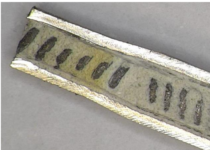
Slika 20: Notranjost grelnega elementa, kontaminiranega z oljem, po segrevanju na 150 °C.
