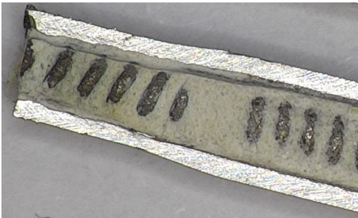
Slika 19: Notranjost grelnega elementa, kontaminiranega z oljem, po segrevanju na 100 °C. Na sliki je razvidno kovinsko ohišje in grelna navitje, ki je obdano z izolacijskim MgO. MgO je na levi strani zaradi kontaminacije z oljem rahlo porumenel.
