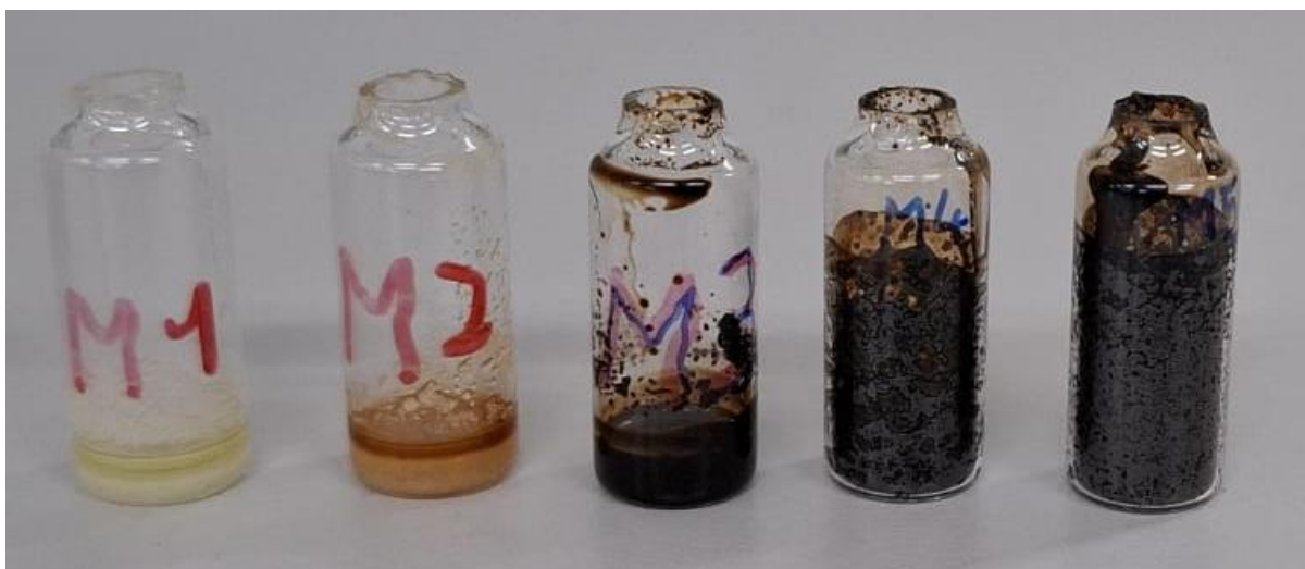
Slika 18: Vzorci olja z magnezitom, ki smo jih za eno uro segreli na 100, 150, 200, 250 in 300 °C (od leve proti desni).
