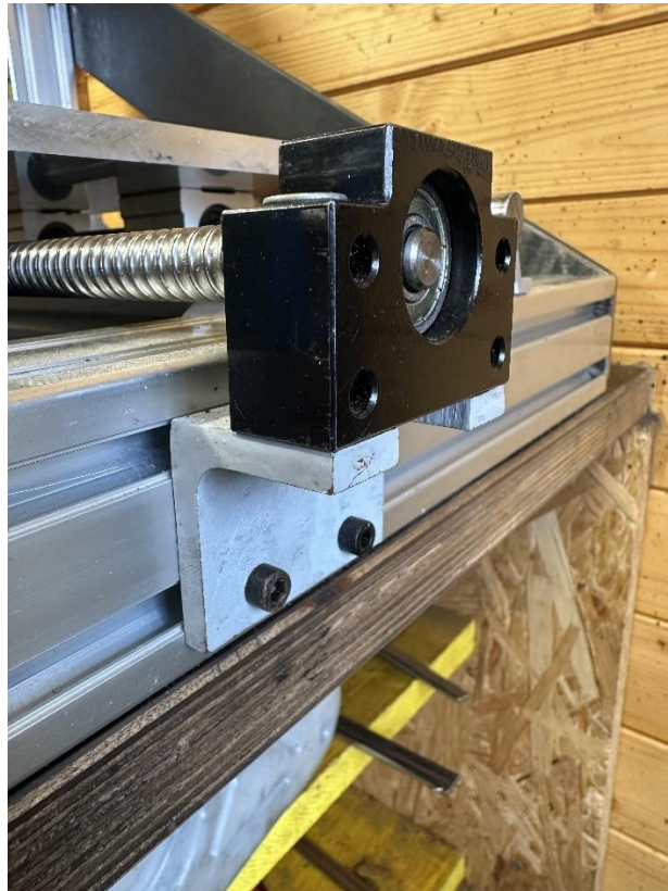
Slika 14: Kroglično vreteno pritrjeno na nosilcu
