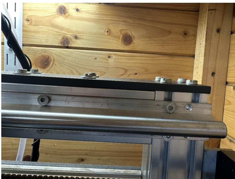
Slika 13: Pritrjeno linearno vodilo
