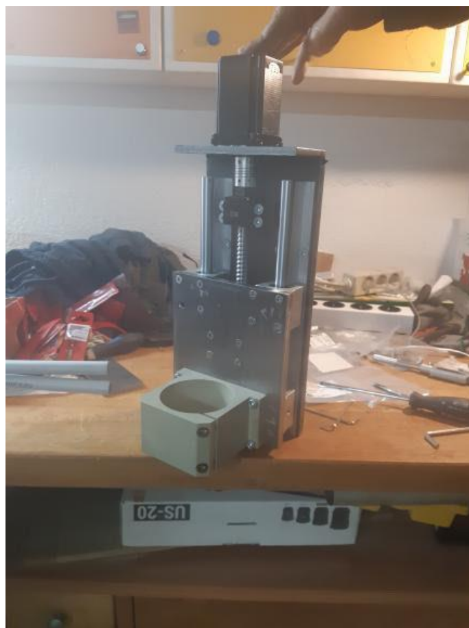
Slika 15: Nosilec Z osi ter vretena
