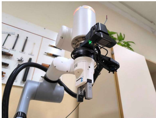
Slika 1: Pritrditev kamere na robotsko roko
