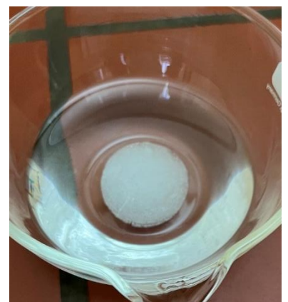
Slika 18: Propanolov aerogel v heksanu pri določanju vpojnosti
