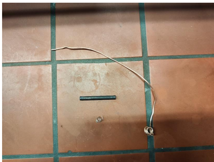
Slika 17: Grafitna elektroda s platinasto žičko in bakreno žico
