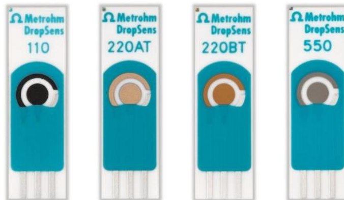
Slika 9: Različni tipi SPE; od leve proti desni delovne elektrode iz ogljika, zlatega filma, zlatih nanodelcev in platine. [21]
