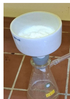
Slika 11: Filtracija pod znižanim tlakom
