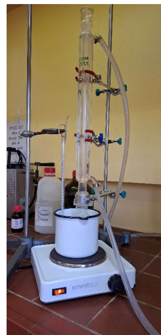
Slika 10: Naprava za povratno destilacijo
