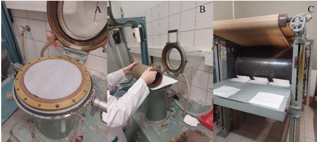
Slika 3: A) Neposušen papir na oblikovalniku B) Valjanje C) Sušilni valj [osebni arhiv]
