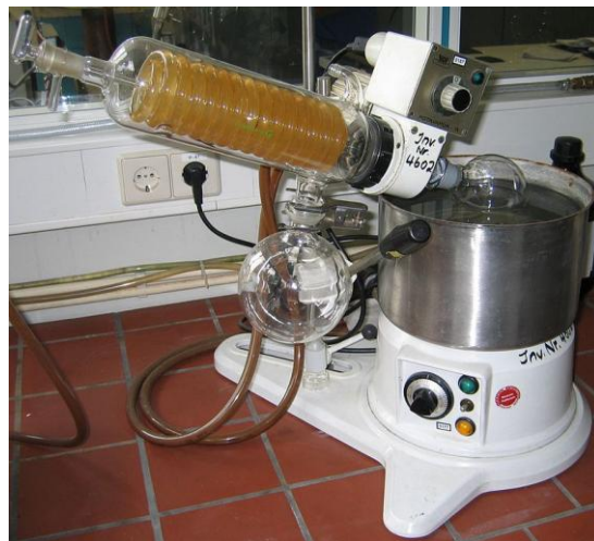
Slika 15. Rotavapor oz. vakuumski uparjalnik.
