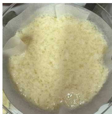
Slika 18: Filtriranje obarjenega kazeina iz polposnetega trajnega mleka s 1,5 % mlečne maščobe
