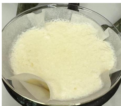
Slika 17: Filtriranje obarjenega kazeina iz polnomastnega trajnega mleka s 3,5 % mlečne maščobe
