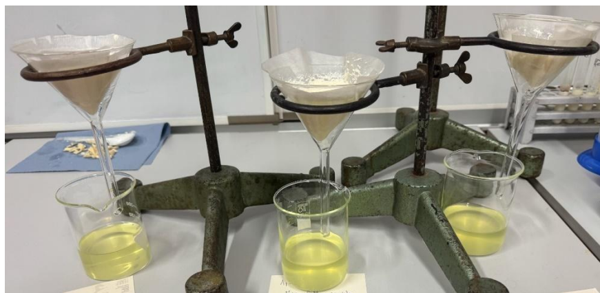
Slika 9: Prikaz postopka filtriranja oborine
