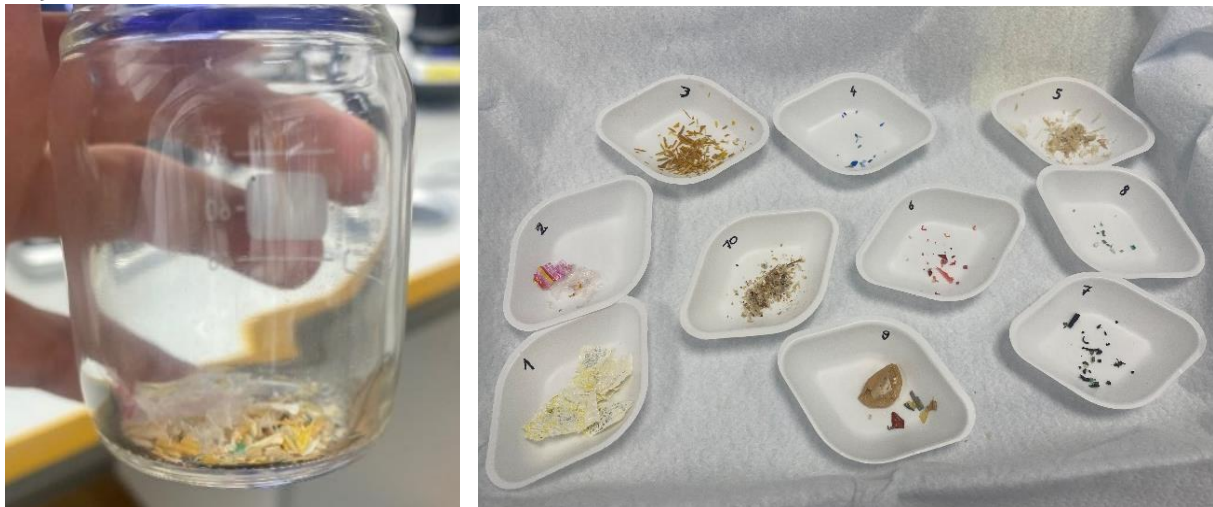
Slika 10: (a) Skupni vzorec zbranih delcev plastike. (b) Banjice posameznih skupin mikroplastike.
