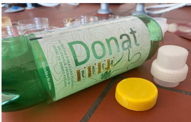
Slika 12: Izbrani viri vrst plastike za pripravo laboratorijsko izdelane mikroplastike (PET-plastenka: HDPE-rumen pokrovček; PP-bel pokrovček).
