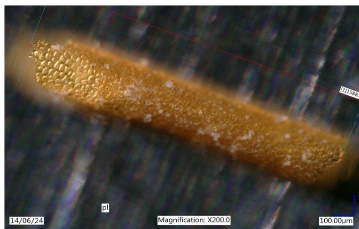
Slika 21: Zajeti delec mikroplastike DPDA 6182 (polietilen etil akrilat).
