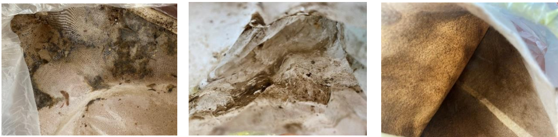
Slika 5: (a) Vsebina 500 \mu\text{m} PET-filtra po odstranitvi. (b) Vsebina 80 \mu\text{m} PET-filtra po odstranitvi. (c) Vsebina 10 \mu\text{m} PET-filtra po odstranitvi.
