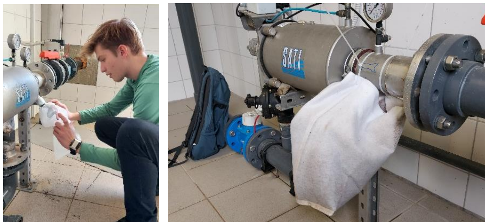
Slika 4: (a) Namestitev PET-filtrov za zajem mikroplastike. (b) Nameščeni filtri.
