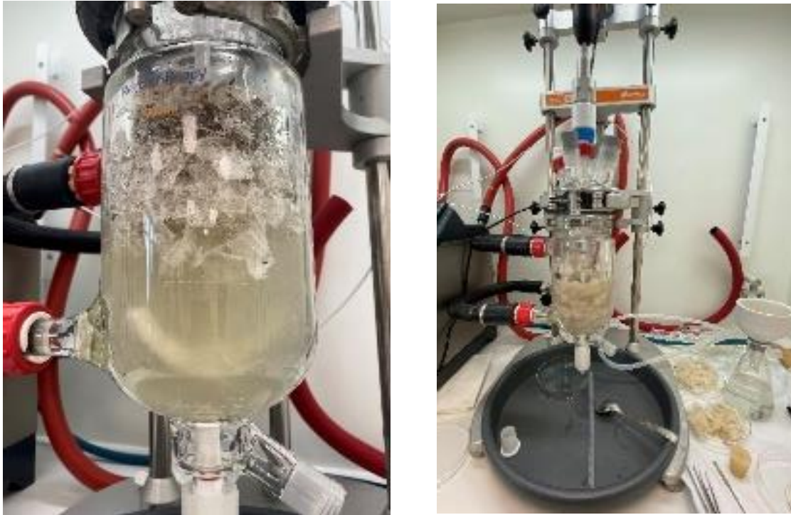
Slika 6: (a) Digestorij z reaktorjem. (b) Oksidacija bioloških snovi v reaktorju.
