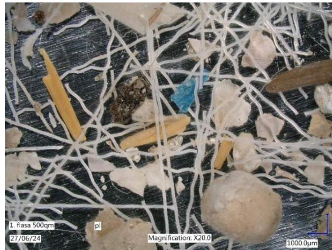
Slika 8: Slika vzorca nekaj zajetih delcev mikroplastike pod mikroskopom na 20-kratni povečavi.
