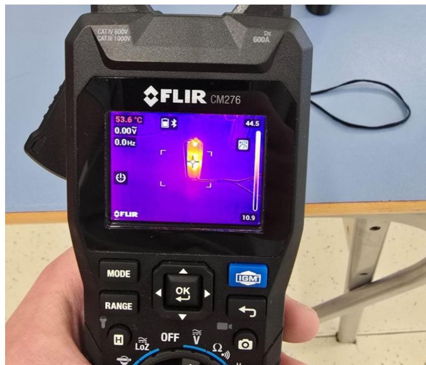
Slika 28: Test gretja končnega izdelka s termalno kamero
