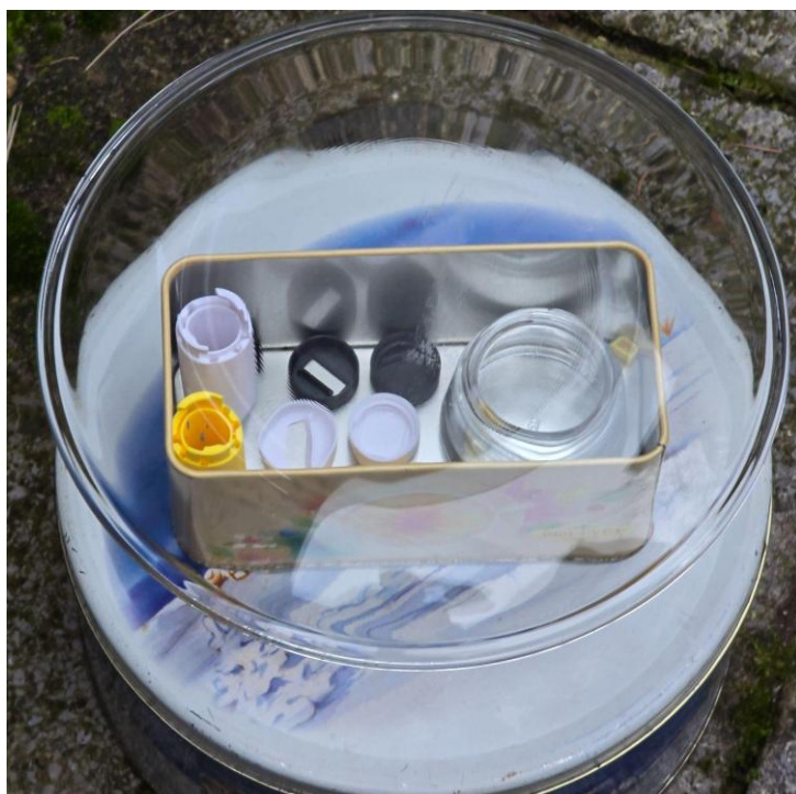
Slika 20: Glajenje s hlapi MEK
