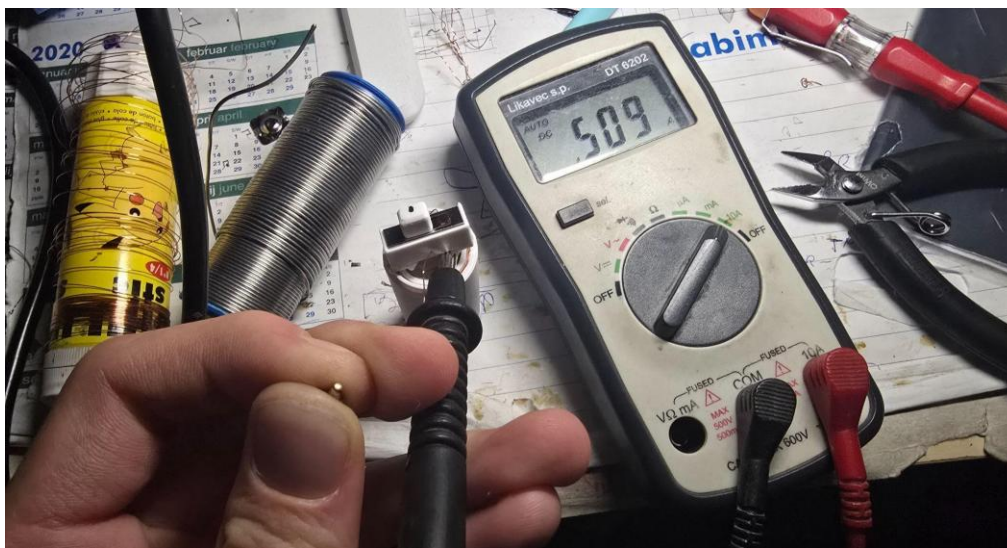
Slika 26: Merjenje toka na najnižji stopnji
