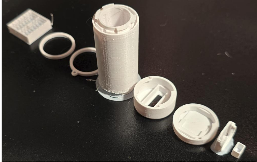
Slika 16: Prvi mehanizem za enostavno sestavljanje
