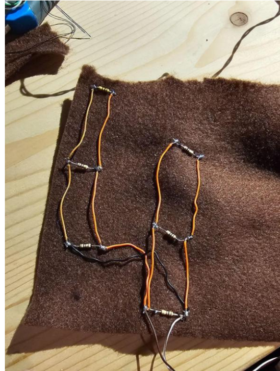
Slika 2: Vezje v vložku za ogrevane pancarje
