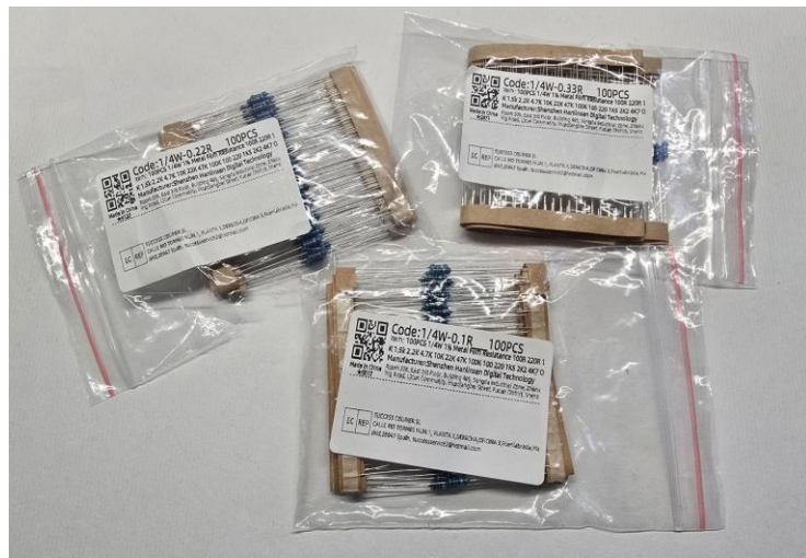
Slika 6: Upori z 0,1 \Omega , 0,22 \Omega , 0,33 \Omega
