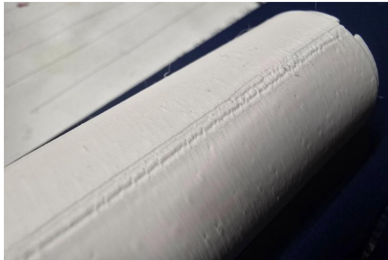
Slika 15: Spojna linija na površini grelca
