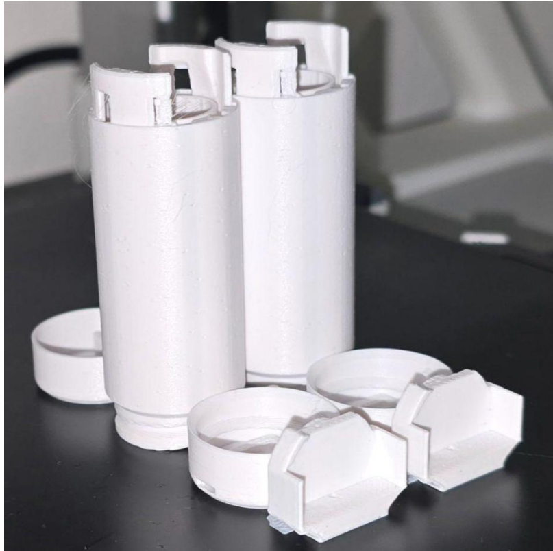
Slika 14: Prototip 3D natisnjen v več kosih, z novim mehanizmom za sestavljanje
