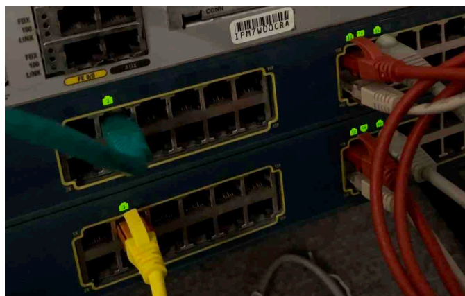
Slika 22: Prikaz stanja vmesnikov ob delovanju Etherchannelja
