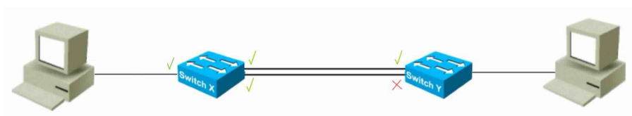
Slika 16: Prikaz stanja vmesnikov med delovanjem STP protokola
