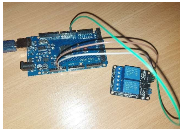
Slika 16: Povezava releja s krmilnim modulom
