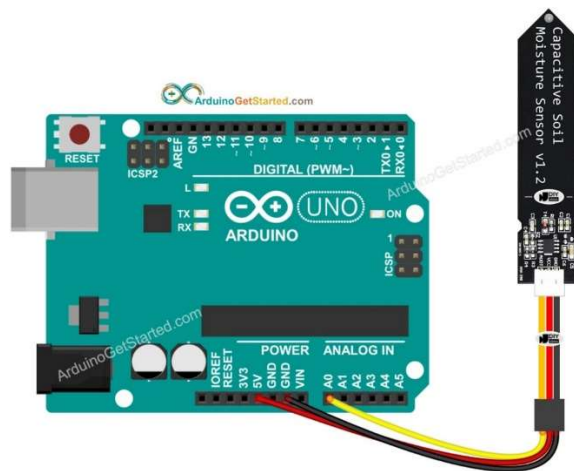
Slika 8: Priključitev senzorja vlažnosti zemlje na krmilni modul
