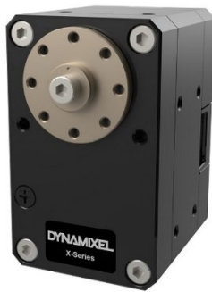
Slika 24: Servomotor Dynamixel XM430-W350-R za pogon koles
