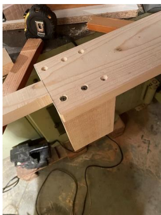
Slika 19: Pritrjevanje stranic za osovino (vir: osebni arhiv)
