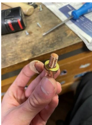
Slika 6: Vrezan navoj na konicah (vir: osebni arhiv)
