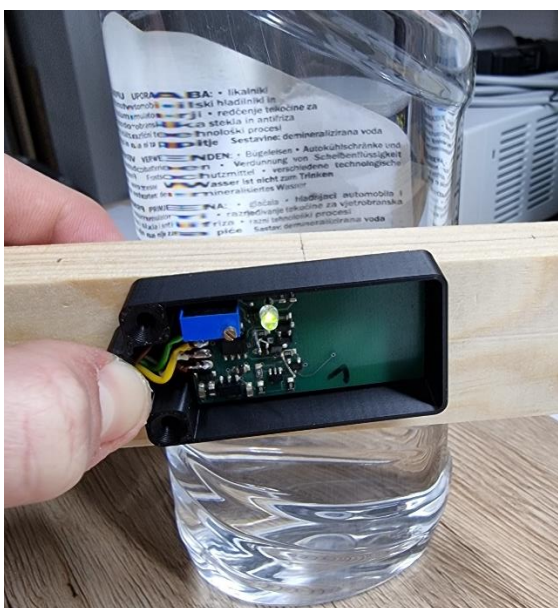
Slika 26: Poizkus zaznavanja vode v plastenki skozi les
