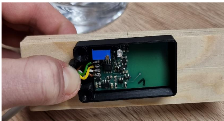
Slika 25: poizkus zaznavanje vode v plastenki skozi les
