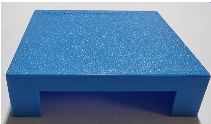
Slika 17: 3D natisnjen pokrov z vidno luknjo za konektorje
