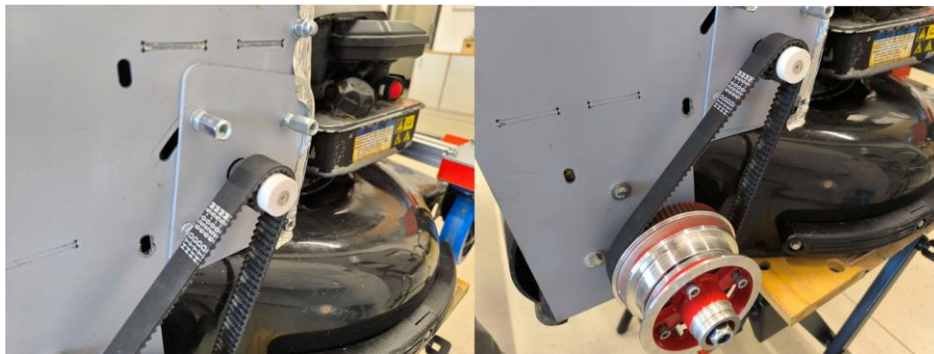
Slika 4-27: prenovljen napenjalni sistem (Avtor fotografij: Erik Curk)
