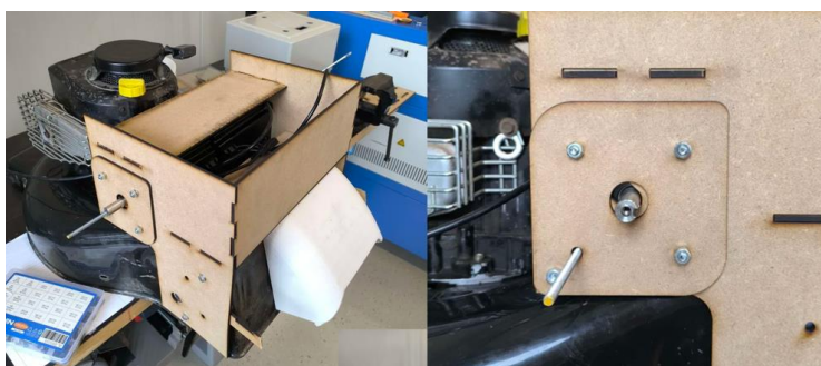
Slika 4-25: ogrodje iz lasersko izrezanih MDF plošč (Avtor fotografij: David Bratina)
