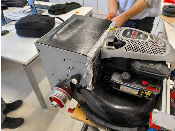
Slika 4-31: Izolirano ogrodje in dokončan pokrov (Avtor fotografije: David Bratina)
