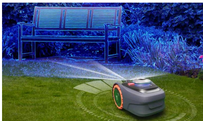
Slika 2-4: Prikaz vidnega polja VSLAM tehnologije na robotski kosilnici [12]
