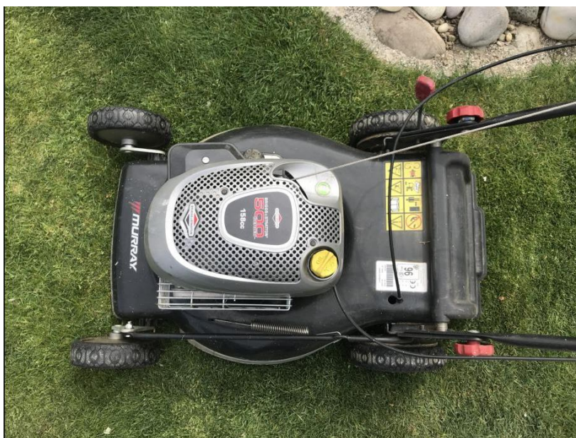
Slika 4-1: Kosilnica Murray z motorjem Briggs & Stratton 500 series 158cc (Avtor fotografije: David Bratina)
