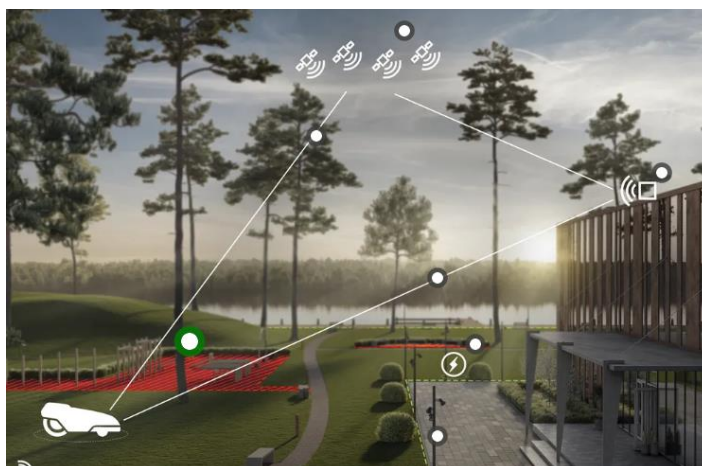
Slika 2-5: Prikaz komuniciranja med kosilnico, referenčno postajo in sateliti [9]
