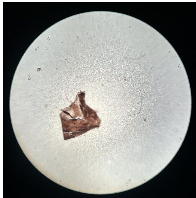
Slika 19: Fragment deske iz PP pod svetlobnim mikroskopom (Vir: osebni arhiv, Zver, 2025)
