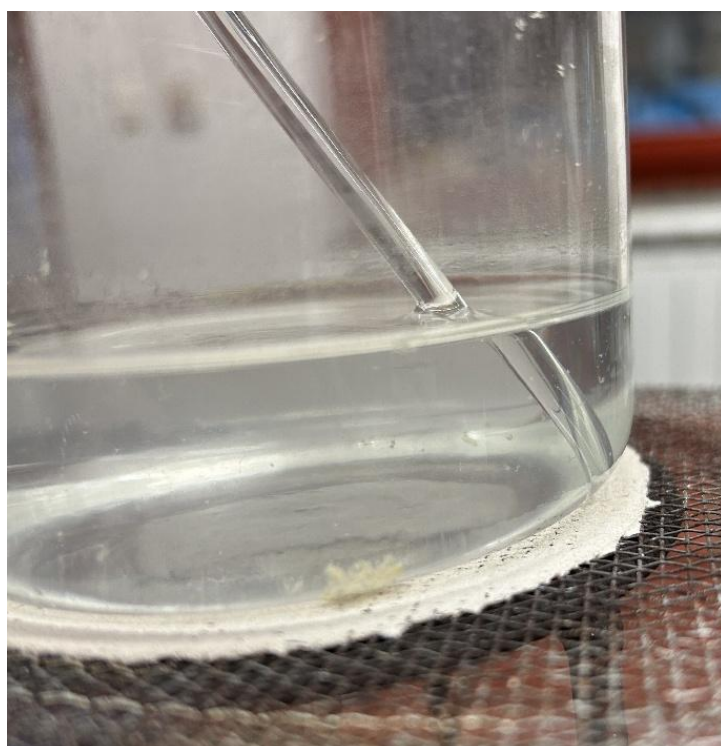
Slika 22: Delci iz zmesi PP in PE po končani termični obdelavi (Vir: osebni arhiv, Zver, 2025)
