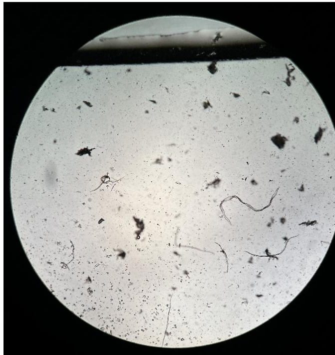
Slika 17: Nastala vlakna pri obrabljeni deski iz PP in AA pod svetlobnim mikroskopom (Vir: osebni arhiv, Zver B., 2025)
