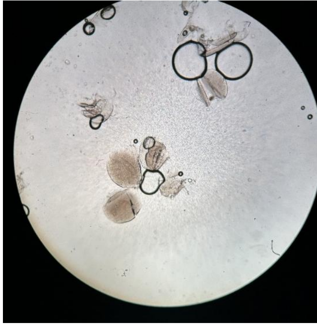
Slika 20: Peleti neobrabljene deske iz PP in PE pod svetlobnim mikroskopom (Vir: osebni arhiv, Zver, 2025)
