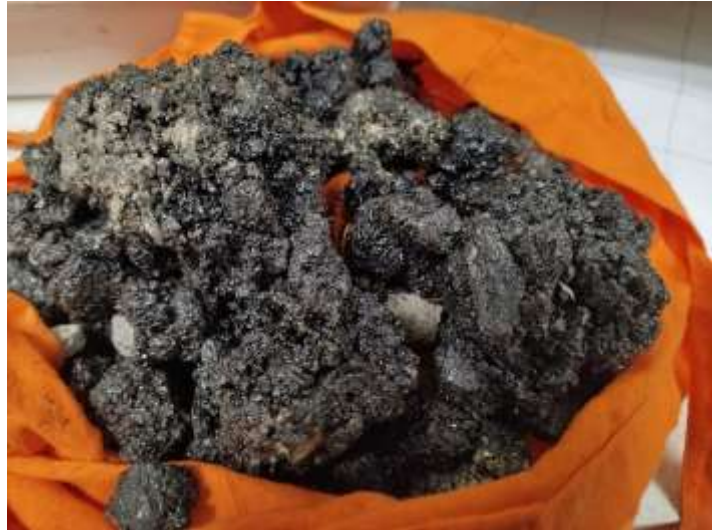
Slika 27: Večji deli svežega asfalta (vir: Tajda Adrovič Flisar, 2025)
