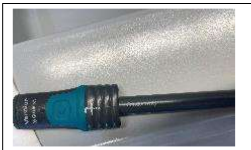
Slika 21 in 22: Sonda za merjenje prevodnosti, ki sem jo uporabil
