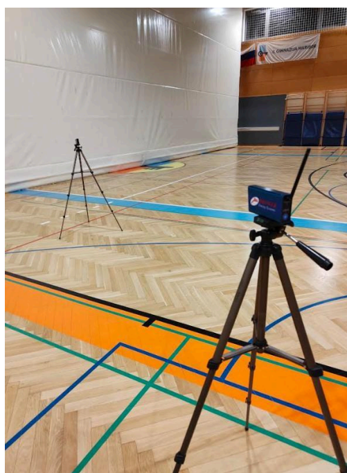
Slika 14: Postavitev fotocelic za merjenje časa šprinta (vir: lasten)
