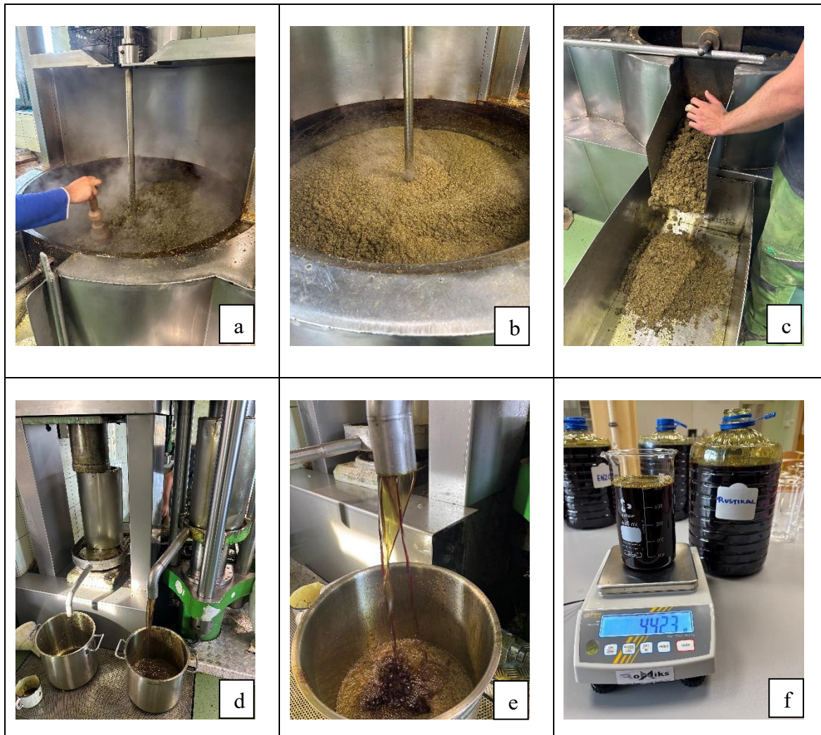
Slika 5: Praženje (slika: a, b in c), stiskanje olja (slika: d, e) in ugotavljanje izplena olja (slika: f) (Vir: Lasten)
