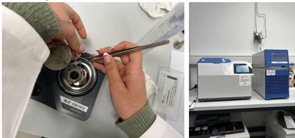
Slika 5: Ovijanje parafinske nitke in bombni kalorimeter
