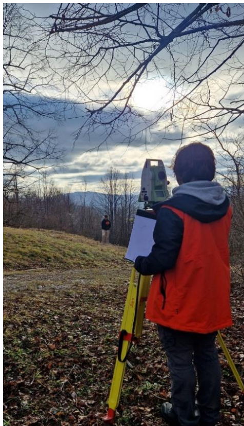
Slika 5: Dijak pri merjenju merilnih točk s klasičnim geodetskim instrumentom – teodolitom.
