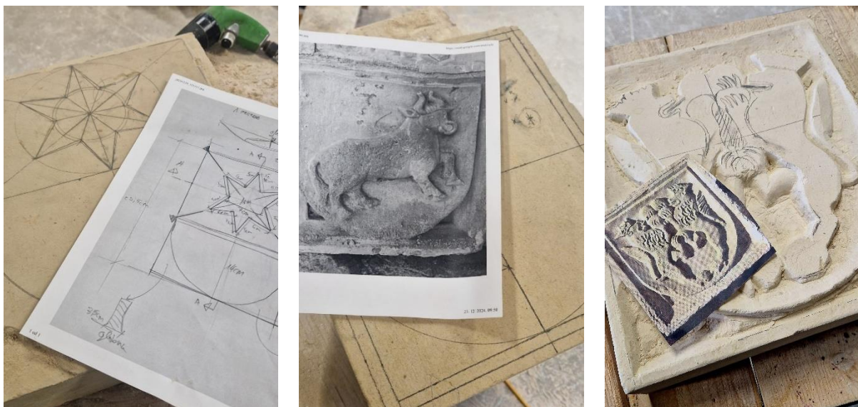
Slika 8: Skice in prenos mer grbovne kompozicije na obdelovanec.
