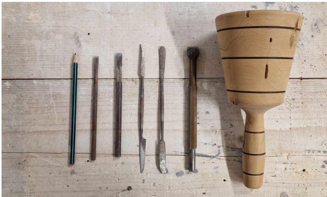
Slika 9: Uporabljeno kamnoseško orodje (od leve proti desni): svinčnik, mali dleti, rašpli, žlebasto dleto in bat.
