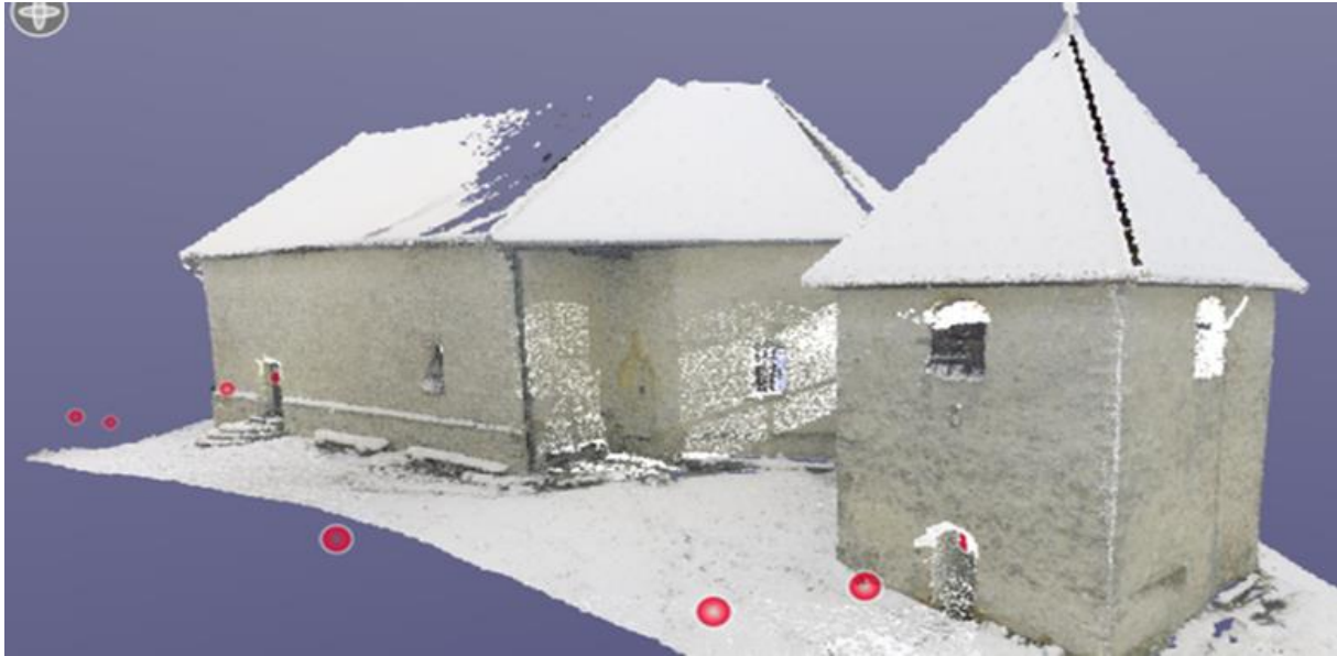
Slika 6: Primer pogleda, ki je bil ustvarjen s tehniko 3D laserskega skeniranja.
