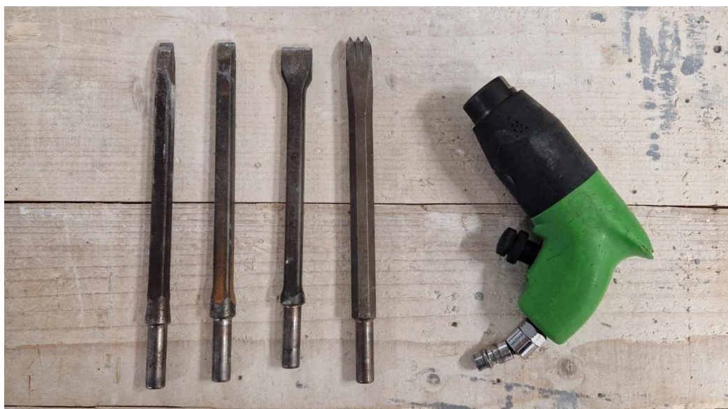
Slika 10: Uporabljeno kamnoseško orodje (od leve proti desni): mali dleti, navadno ravno dleto in zobato dleto, ki se namestijo v pnevmatsko pištolo.
