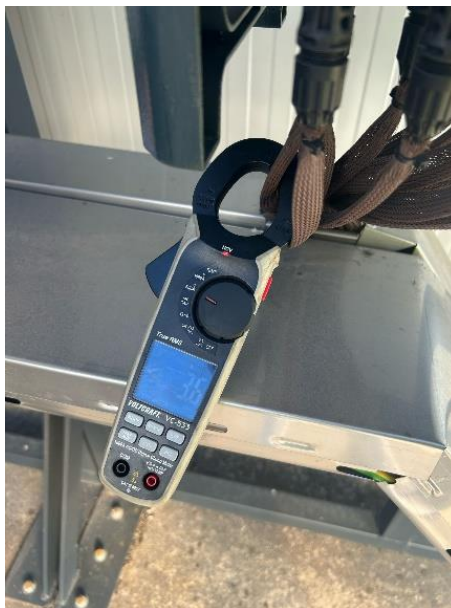
Slika 29: Meritev s tokovnimi kleščami (lastni vir)
