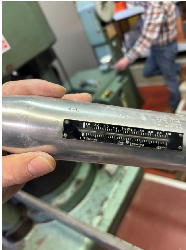
Slika 33: Merjenje površinske trdnosti betona
