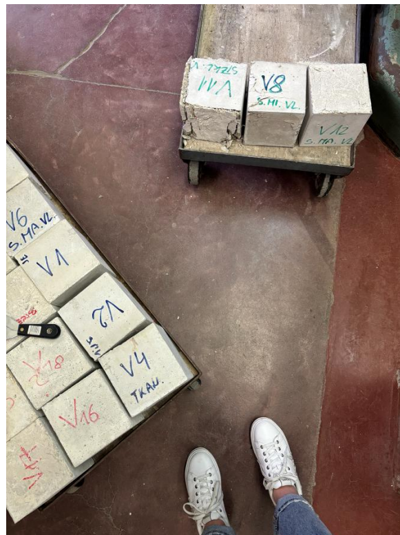
Slika 34: Porušene in neporušeni kocke betona
