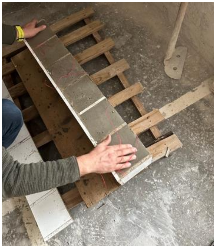
Slika 29: Razopaževanje betonskih vzorcev, drugi dan po betoniranju.
