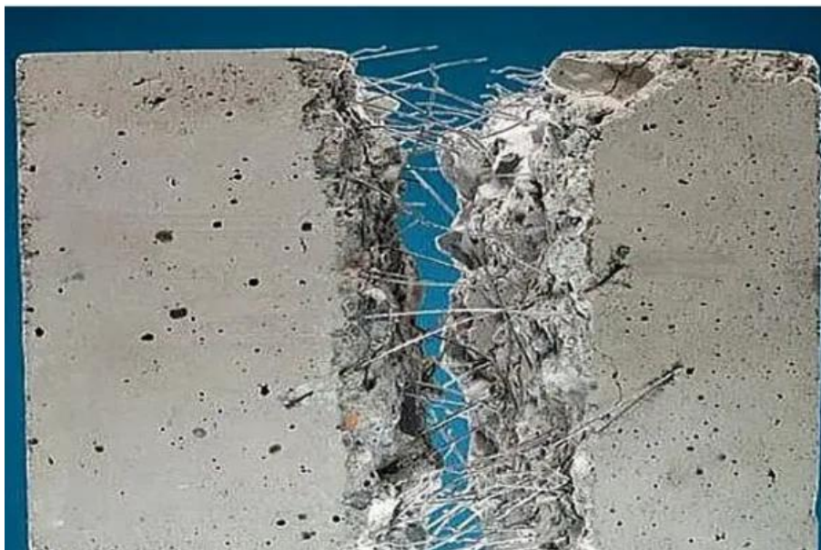
Slika 8: Dodatki v betonu – mikor jeklena armatura
