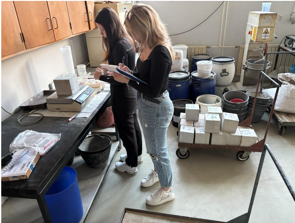
Slika 31: Tehtanje betonskih kock
