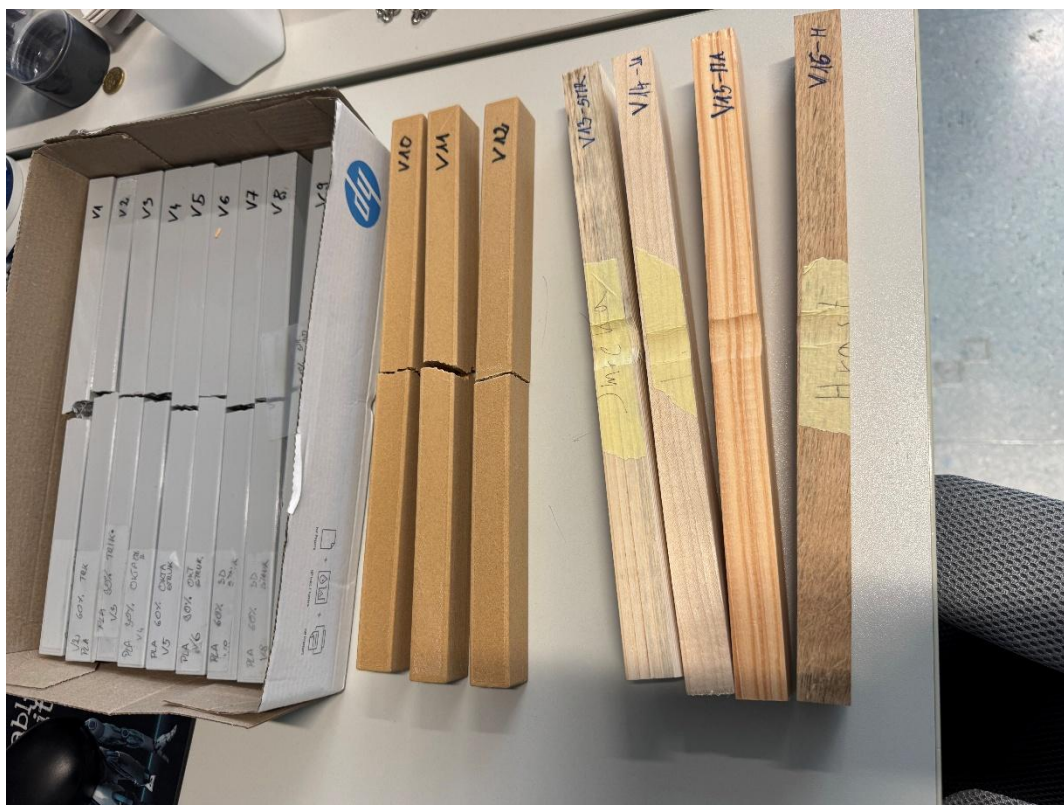
Slika 36: Prikaz preizkušancev po testiranju (porušeni)
