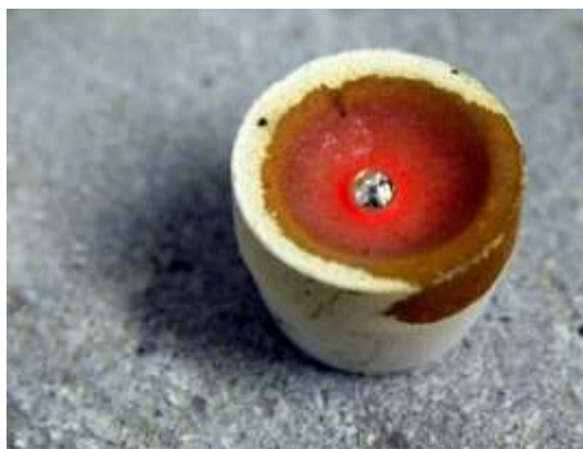
Slika 38: Žarilni lonček s kroglico zlata (Viri: MIRS CE, 2025)
