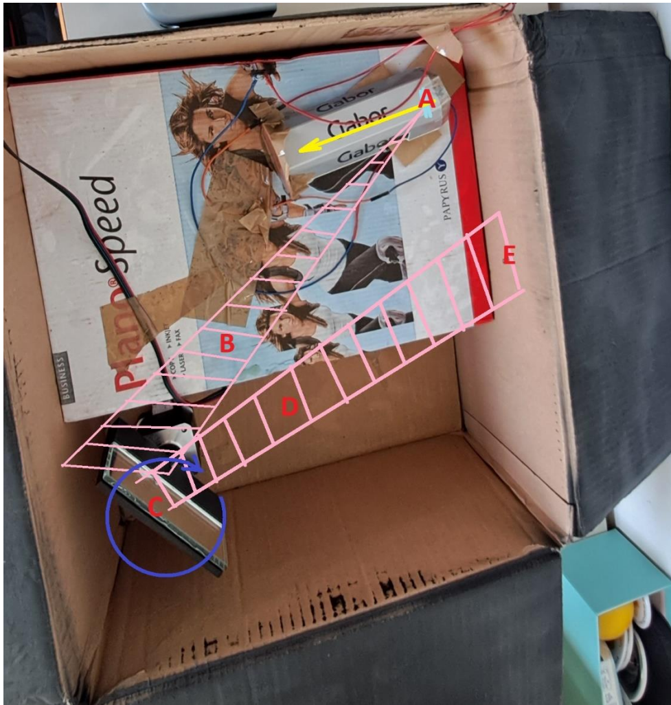
Slika 5 Notranja zgradba spektrometra
