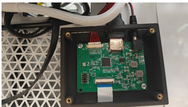
Slika 20: Namestitev LCD kontrolne plošče (lasten vir)
