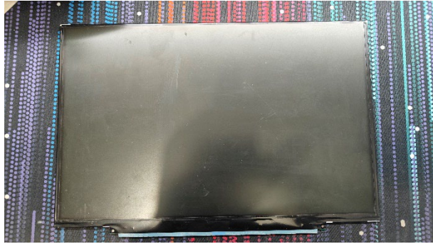
Slika 8: Sprednja stran LCD zaslona, ki sva ga odstranila iz prenosnega računalnika (lasten vir)
