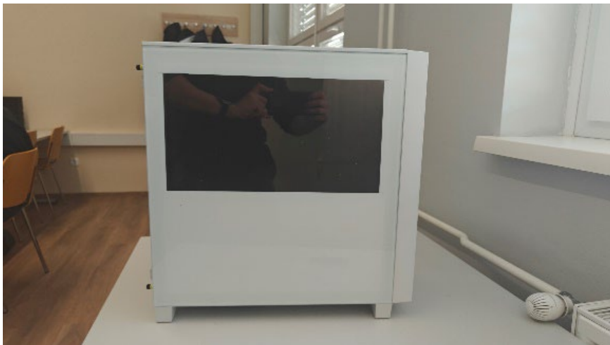
Slika 21: LCD zaslon brez delujočega LED traku (lasten vir)
