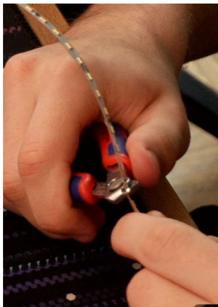
Slika 15: Rezanje LED traka na željeno dolžino (lasten vir)
