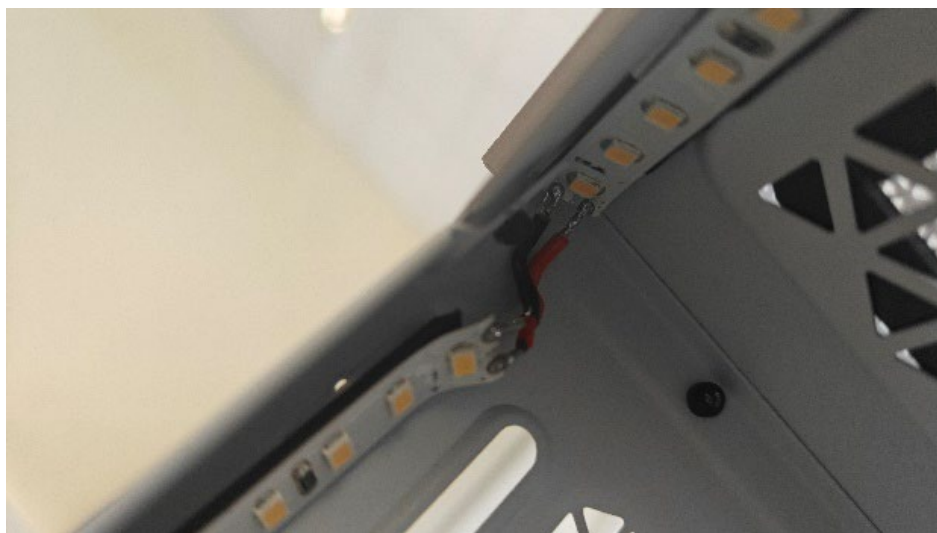
Slika 16: Povezava med dvema LED trakovima (lasten vir)
