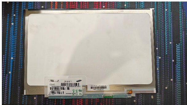
Slika 9: Zadnja stran LCD zaslona, ki sva ga odstranila iz prenosnega računalnika (lasten vir)
