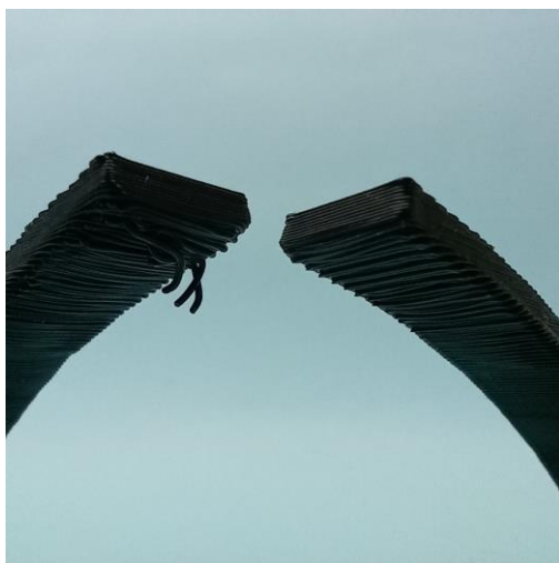
Slika 6: 75° previs na vrhu tiskanega modela (levi izdelek je bil natisnjen brez podpor, desni pa z njimi)
