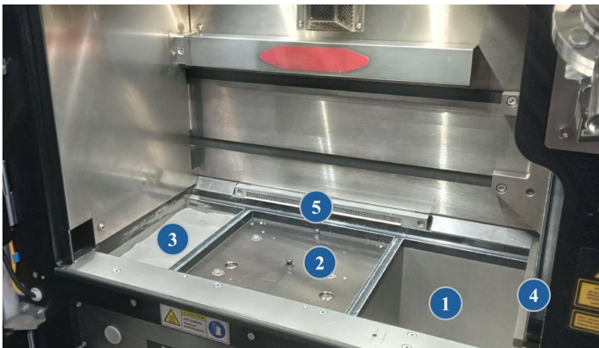
Slika 15: Izgled komore SLM tiskalnika (po končanem tiskanju in z odvzeto zalogo materiala in površino za tiskanje)
