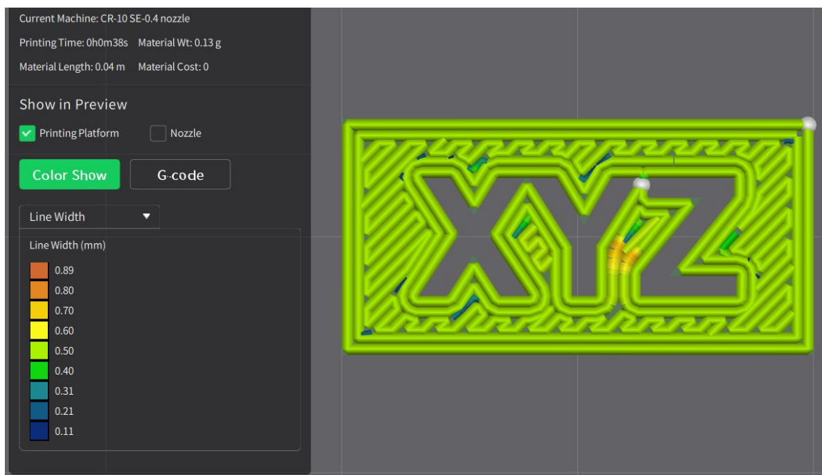
Slika 20: Posnetek zaslona s predogledom tiskanja testnega modela glede na širino slojev. Vključena je tudi legenda (gl. levi del posnetka zaslona). V večini je sloj širok okoli 420 \mu\text{m} .
