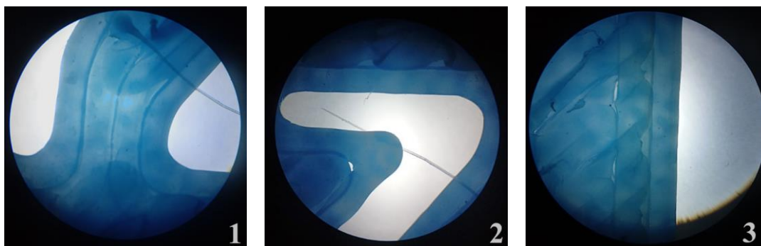
Slika 21, 22 in 23: Pogled testnega modela z optimalno oddaljenostjo šobe od površine za tiskanje pod mikroskopom s 40-kratno povečavo.
