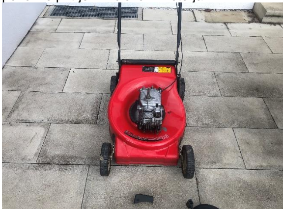
Slika 18: Starejša kosilnica z očiščenim in ponovno pritrjenim blokom motorja
