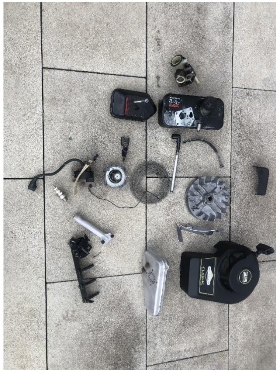
Slika 17: Obnovljeni in očiščeni deli starejše kosilnice
