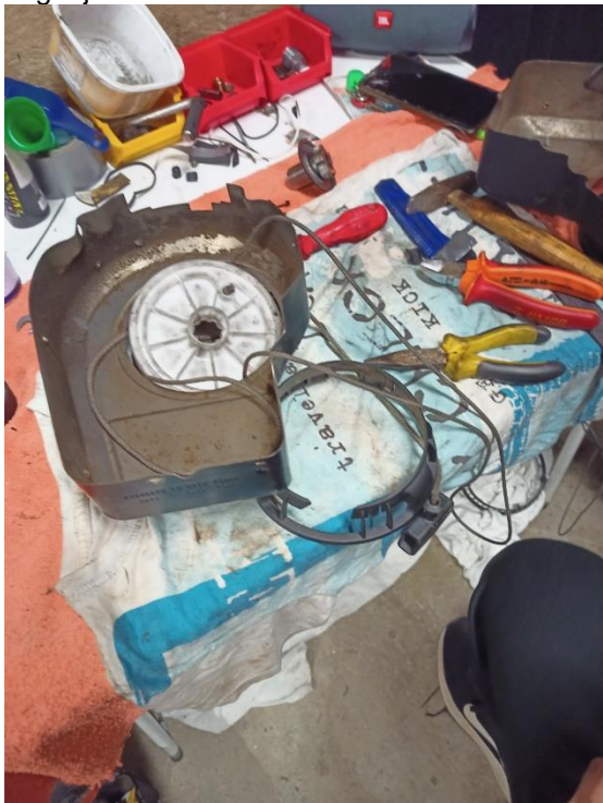
Slika 16: Poskus popravila povratnega zaganjalnika
