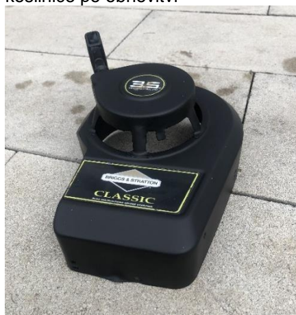
Slika 6: Povratni zaganjalnik s pokrovom kosilnice po obnovitvi
