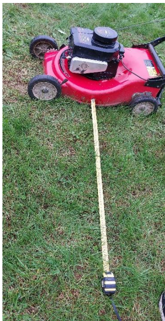
Slika 14: Določitev razdalje enega metra za merjenje hrupa
