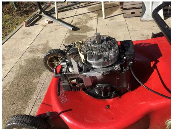
Slika 19: Skoraj v celoti sestavljena starejša kosilnica z obnovljenimi in očiščenimi deli
