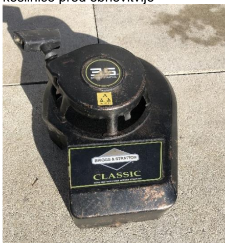
Slika 5: Povratni zaganjalnik s pokrovom kosilnice pred obnovitvijo
