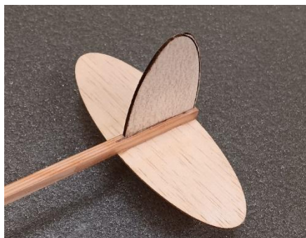
Slika 4: Rep raketoplana. (Lasten vir)
