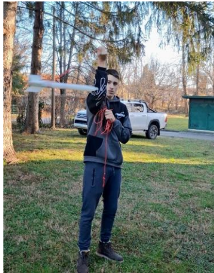
Slika 13: Preizkušanje stabilnosti rakete. (osebni arhiv)
