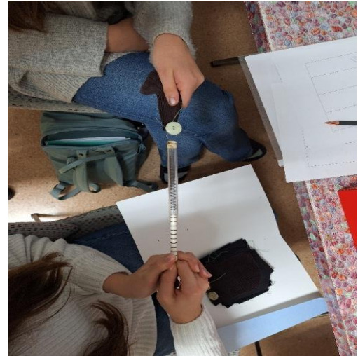
Slika 7 in slika 8: Preverjanje prišitih gumbov s silometrom. (Sobotič, 2024)
